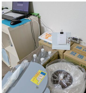
右下に見えるのが、ベラルーシ製の測定器です。真ん中にマウベシコーヒーをセットしています。測定は、厚い鉛のふたを閉めて行います。測定データは左上のPCにオンラインで表示され、保存することができます。
